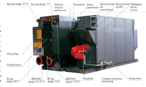
жания чистоты раствора. Кроме того, все входящие патрубки воды оснащены фильтрами из нержавеющей стали для предотвращения засорений теплообменников холодильной машины.
